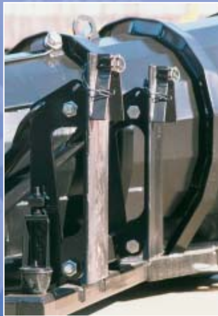
Duolift påmontert. Hurtigkoblingsgafler som muliggjør enkel anvendelse av ett parallelogram på flere ploger. Det kreves mindre olje og trykk for å betjene plogen enn tidligere, noe som gjør at løftet blir raskere og sikrere.
