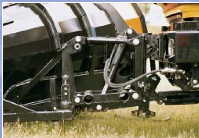
Vuggen med utskiftbare foringer i opplagringshullene mot parallelogrammet
