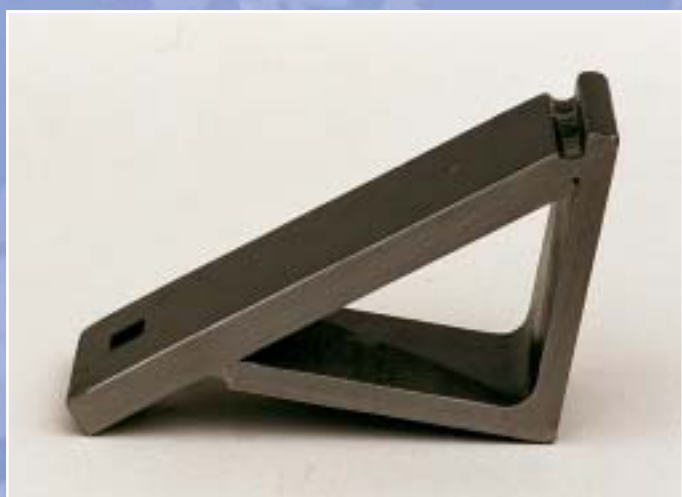
Vuggen med utskiftbare foringer i opplagringshullene mot parallelogrammet
