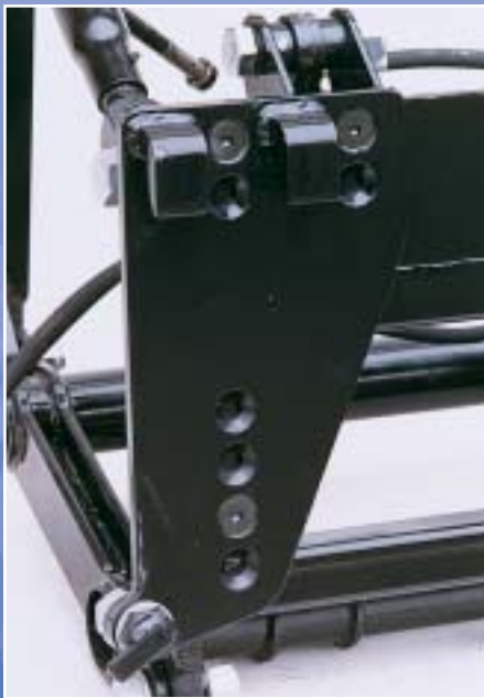
Bildene viser parallelogrammets bakvegg med høyderegulering som gjør at man kan kompensere 150 mm i forhold til «feil» montert bilplate på bil/bæremaskin.
